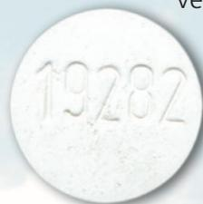
Verschiedene Sicherheitseinrichtungen gewährleisten, dass immer nur ein Verstorbener eingäschert werden kann, und dass die jeweilige Asche in die dazugehörige Urne verbracht wird. Eine dieser Sicherheiten ist unser Schamottstein, welcher mit der einmalig vergebenen Nummer des Verstorbenen geprägt wird und vor der Einäscherung am Sarg sichtbar angebracht wird.
